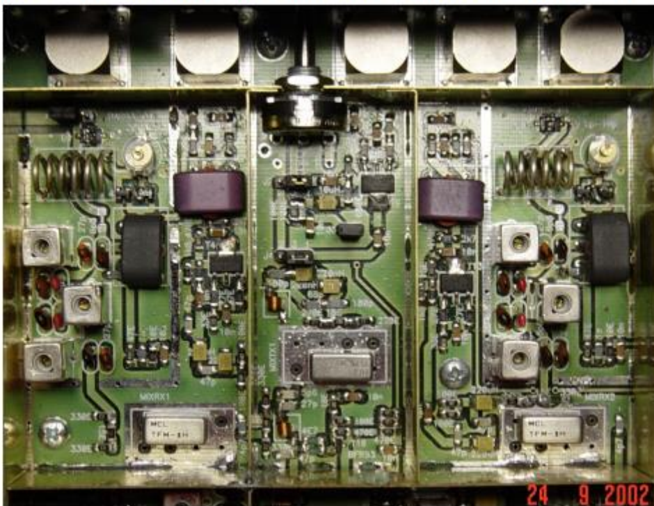
Slika 6: Oba sprejemna konvertererja in vhodni IF ojačevalnik z mešalci
